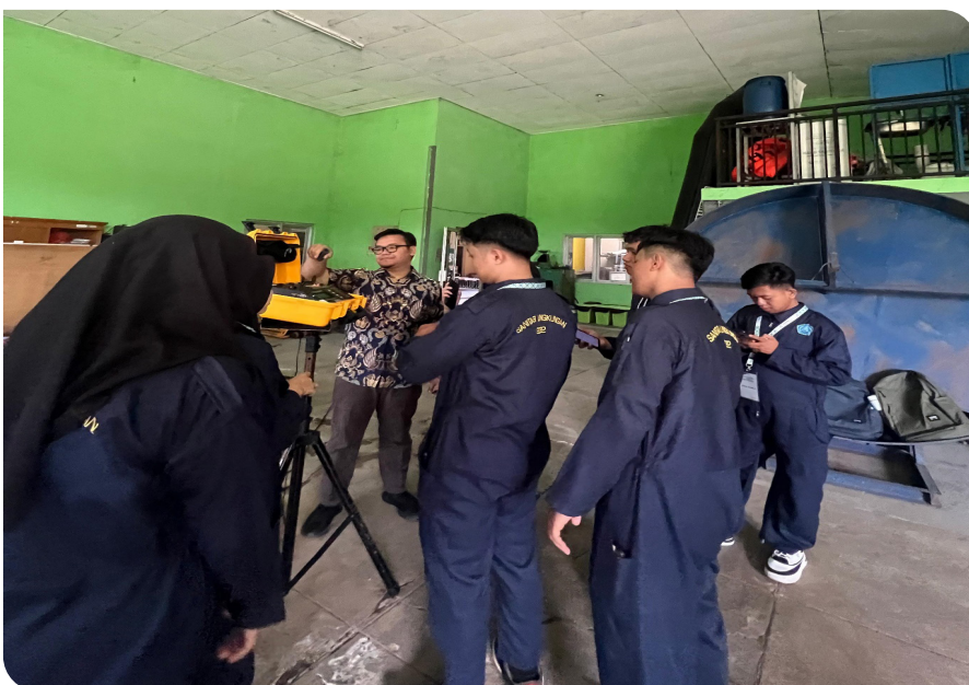
Sampling Partikulat Debu (Udara Ambien) dengan Haz Dust EPAM-5000
